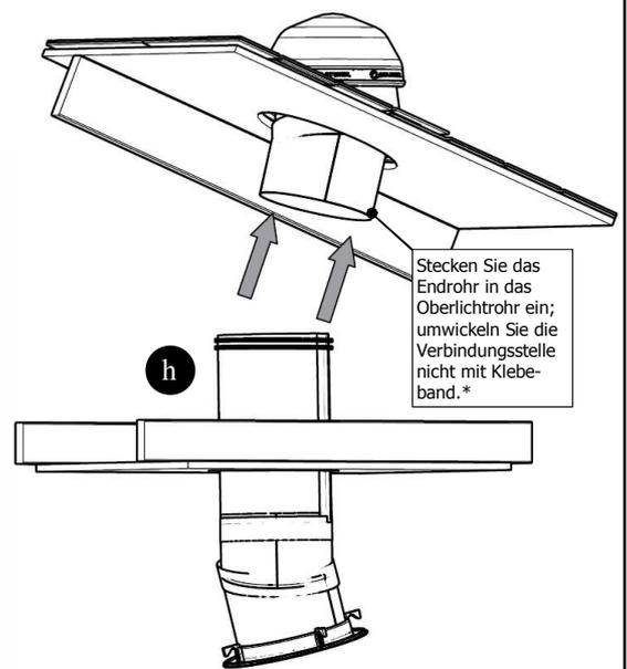
\*Bei einer kommerziellen Montage mit abgehängter Decke wird die Verbindungsstelle mit Klebeband umwickelt.
